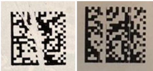
Нарушение целостности КМ*
